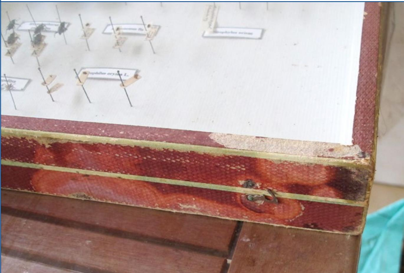
Photo 3 : Décoloration et détérioration prononcée du bord d'une boîte.
